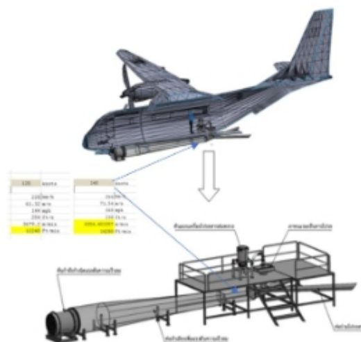
ภาพที่ ๑ แนวคิดการทำงานและลักษณะต้นแบบระบบโปรยสารฝนหลวง
