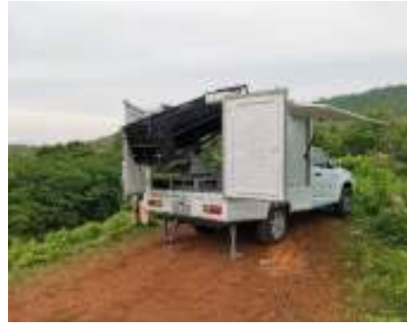
รูปที่ ๒ (ซ้าย) ฐานยิงจรวดแบบลากจูง (ขวา) ฐานยิงจรวดแบบเคลื่อนที่
