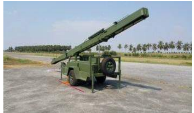
รูปที่ ๓ การสร้าง Airframe และสร้างแท่นยิงเครื่องบินเป้าอากาศไร้คนขับ
