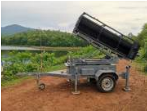
รูปที่ ๒ (ซ้าย) ฐานยิงจรวดแบบลากจูง (ขวา) ฐานยิงจรวดแบบเคลื่อนที่
