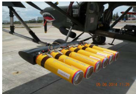
ภาพที่ ๒ ติดตั้งเครื่องมือ/อุปกรณ์ระบบจุดพลุ
