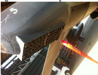
รูปภาพที่ ๔ จบท.สรรพาวุธ ทำการติดตั้งพลู AgI แล้วเสร็จพร้อมทำการบิน
