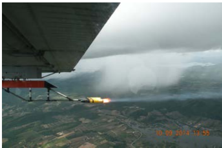
ภาพที่ ๑ เครื่องบิน AU-23A บินจุดพลุทำฝน
