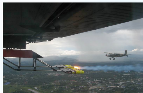
ภาพที่ ๒ เครื่องบิน AU-๒๓A ของกองทัพอากาศ ติดตั้งพลุสารดูดความชื้น สูตรร้อน “แคลเซียมคลอไรด์” และระบบจุดพลุบนเครื่องบิน และทดสอบการทำฝน
