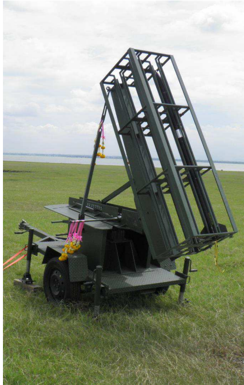
ภาพที่ ๙ แสดงฐานที่ใช้ในการยิงทดสอบจรวดดัดแปรสภาพอากาศภาคพลวัตร
