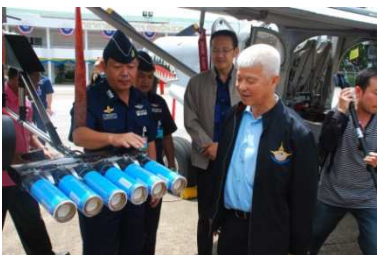
ภาพที่ ๑ พลุสารดูดความชื้น สูตรแกน “โซเดียมคลอไรด์” พร้อมติดตั้งอุปกรณ์จุดพลุ (Flare Rack/Dispenser)
