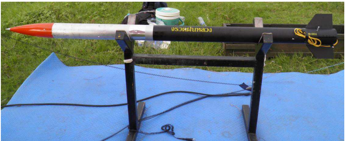
ภาพที่ ๘ แสดงจรวดดัดแปรสภาพอากาศที่ใช้ในการทดสอบ
