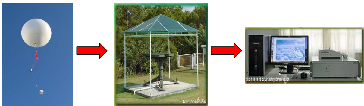
ภาพที่ ๓ ระบบการปฏิบัติการตรวจอากาศด้วยวิทยุหยั่งอากาศติดบอลลูน
