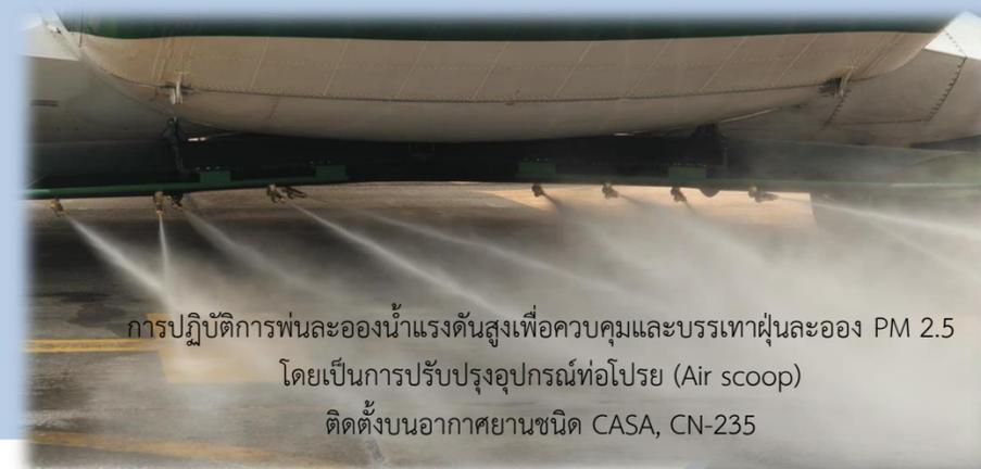
การปฏิบัติการฟ่นละอองน้ำแรงดันสูงเพื่อควบคุมและบรรเทาฝุ่นละออง PM 2.5 โดยเป็นการปรับปรุงอุปกรณ์ท่อโปรย (Air scoop) ติดตั้งบนอากาศยานชนิด CASA, CN-235
