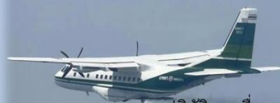
การปฏิบัติการเพื่อลดอุณหภูมิชั้นอุณหภูมิมกผัน ให้อากาศระบายได้ดีและลดความหนาแน่นของหมอกควัน บินโปรยน้ำแข็งแห้ง โดยใช้อากาศยานชนิด CN,CASA-235
