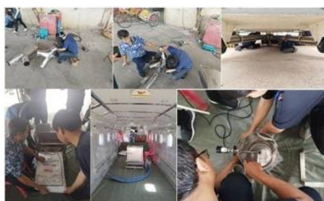
รูปที่ ๒ การติดตั้ง Ejector และระบบกลไกช่วยในการยกเทสารฝนหลวงกับเครื่องบิน CASA
