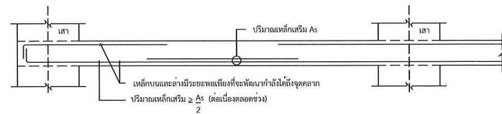
(ค) รายละเอียดการเสริมเหล็กในแถบกลาง
