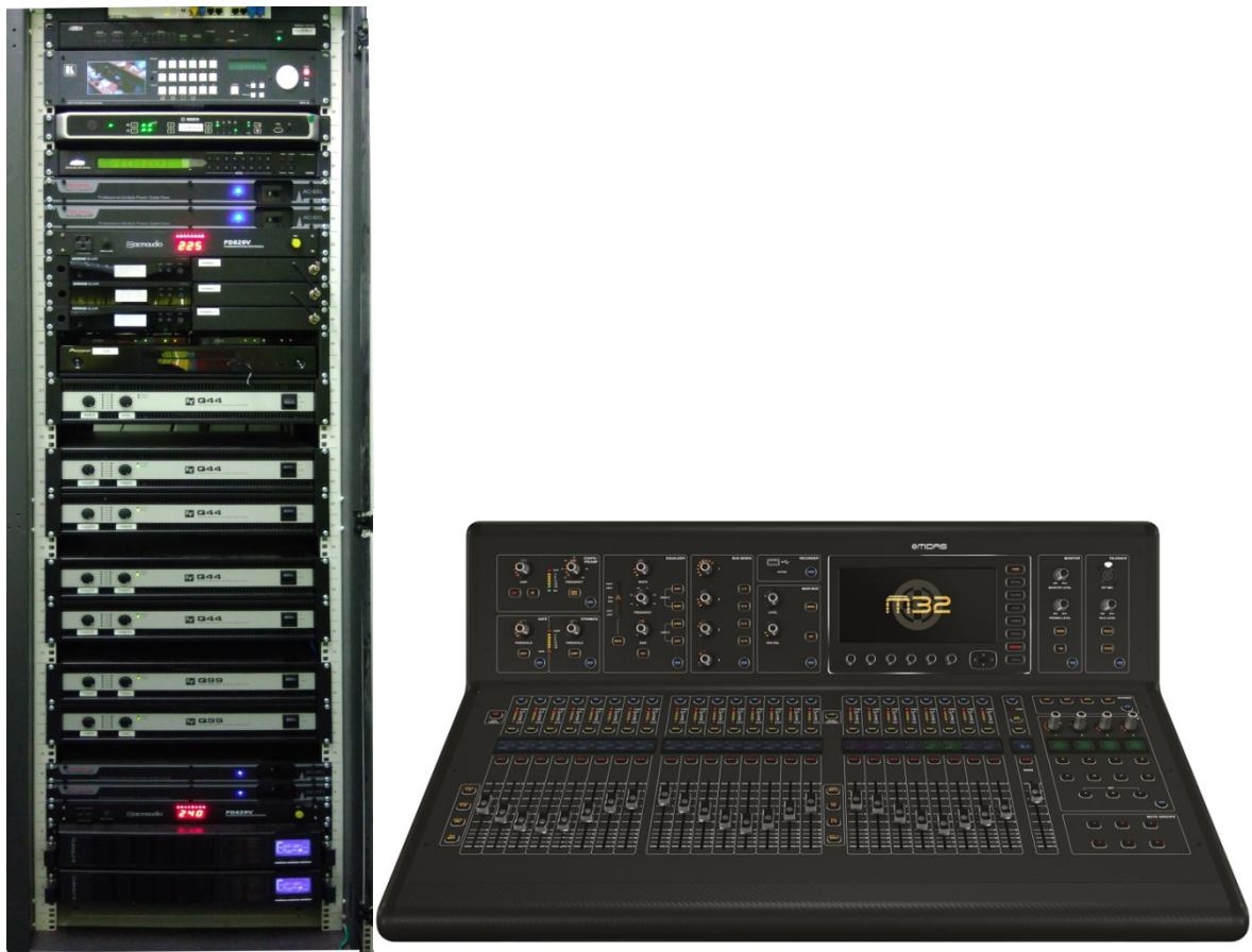
ภาพที่ 2 ตู้ Rack ใส่อุปกรณ์ขยายเสียงและ Mixer ควบคุม Input/Output ของระบบเสียง
