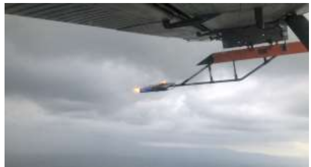
ภาพที่ 2.17 แสดงติดตั้งอุปกรณ์สำหรับพลุสารดูดความชื้นและการใช้พลุสารดูดความชื้นเครื่องบิน AU - 23A (ซ้าย) และรูปแบบการบินในการใช้พลุสารดูดความชื้น (ขวา)
