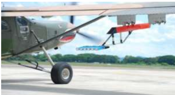
ภาพที่ 2.17 แสดงติดตั้งอุปกรณ์สำหรับพลุสารดูดความชื้นและการใช้พลุสารดูดความชื้นเครื่องบิน AU - 23A (ซ้าย) และรูปแบบการบินในการใช้พลุสารดูดความชื้น (ขวา)
