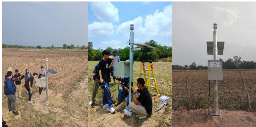
ภาพที่ ๑ การติดตั้งสถานีตรวจอากาศและความชื้นดินอัตโนมัติ
