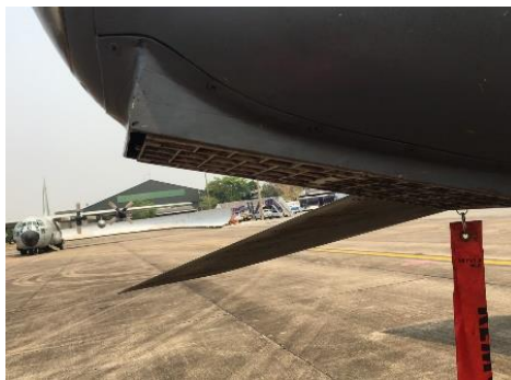
ภาพที่ ๑๓ การบรรจุและติดตั้งพลุซิลเวอร์ไอโอไดด์กับอากาศยานชนิด Alpha Jet
