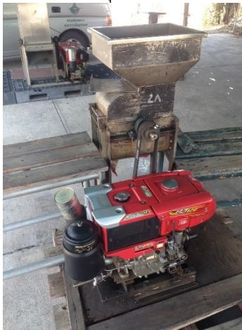
ค. เครื่องลดขนาดอนุภาคสารปนหลวงสูตร ๔ และสูตร ๑๙
