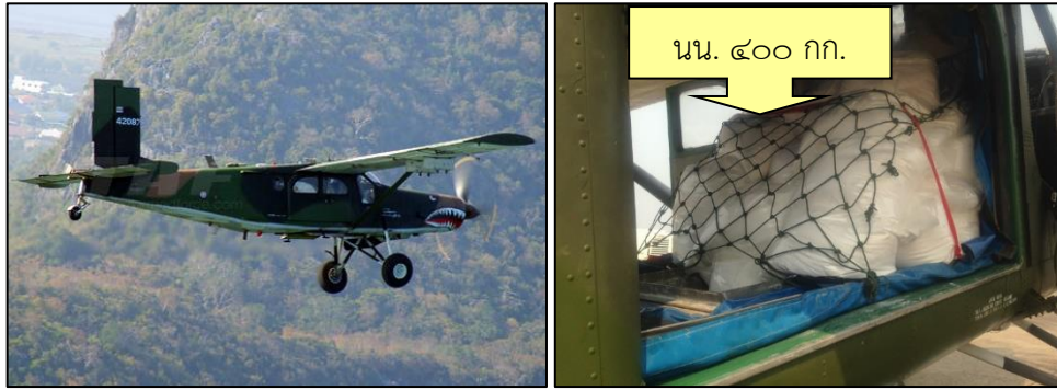
ภาพที่ ๑๐ ลักษณะการเรียงสารฟลางบนอากาศยานชนิด AU-๒๓
