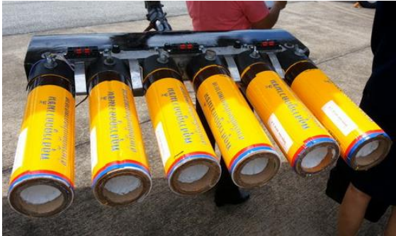
ภาพที่ ๑๔ การบรรจุและติดตั้งพลุดูดความชื้นสูตรโซเดียมคลอไรด์บริเวณใต้ปีกของอากาศยานชนิด AU-๒๓
