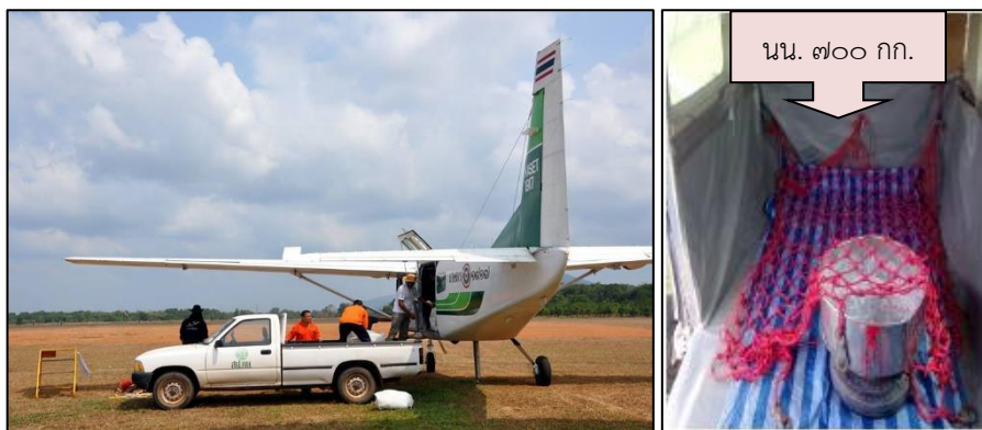
ภาพที่ ๖ ลักษณะการเรียงสารปนหลวงบนอากาศยานชนิด CARAVAN
