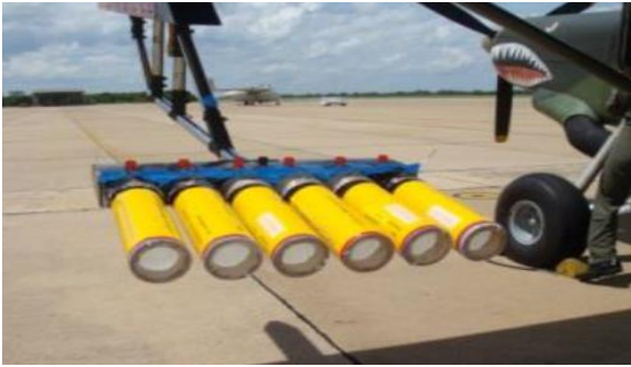
ภาพที่ ๑๔ การบรรจุและติดตั้งพลุดูดความชื้นสูตรโซเดียมคลอไรด์บริเวณใต้ปีกของอากาศยานชนิด AU-๒๓
