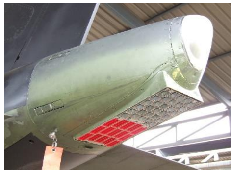
ภาพที่ ๑๓ การบรรจุและติดตั้งพลุซิลเวอร์ไอโอไดด์กับอากาศยานชนิด Alpha Jet
