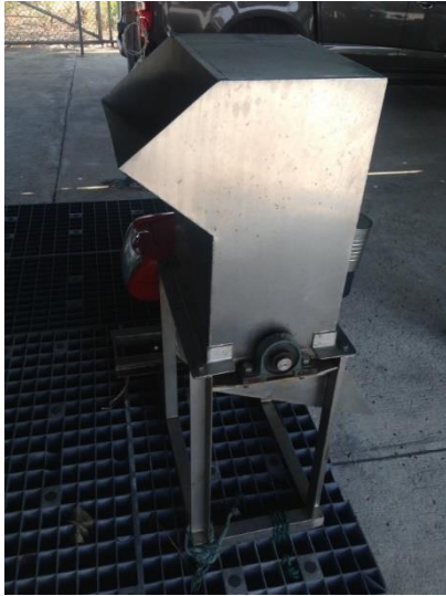
ก. เครื่องลดขนาดอนุภาคสารปนหลวงสูตร ๓
