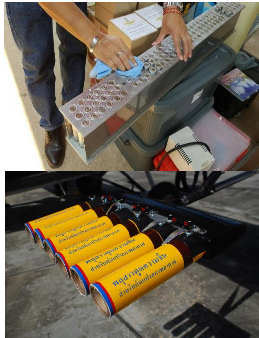
ภาพที่ ๑๑ การบรรจุสารฟลางฟลูซิเวอร์ไอโอไดต์ (Agl) และฟลูดูดความชื้น (Hygroscopic Flares)
