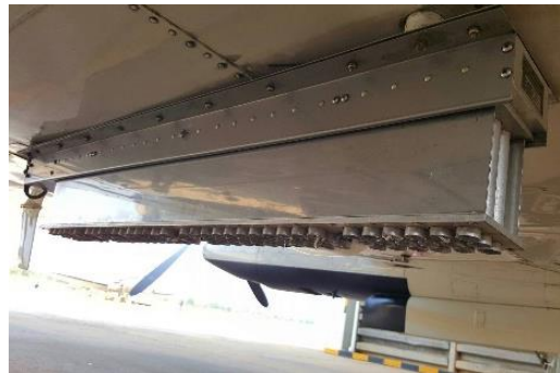
ภาพที่ ๑๒ การบรรจุและติดตั้งพลุซิลเวอร์ไอโอไดด์กับอากาศยานชนิด Super King Air (SKA)
