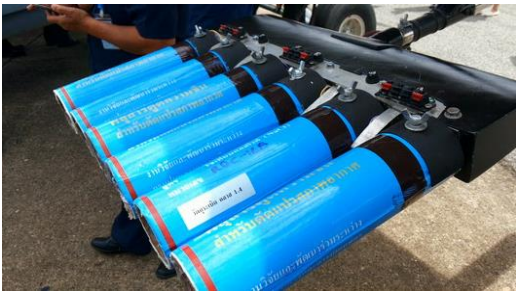
ภาพที่ ๑๕ การบรรจุและติดตั้งพลุดูดความชื้นสูตรแคลเซียมคลอไรด์บริเวณใต้ปีกของอากาศยานชนิด AU-๒๓
