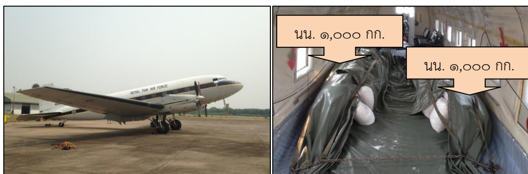
ภาพที่ ๙ ลักษณะการจัดเรียงสารปนหลวงบนอากาศยานชนิด BT-๖๗
