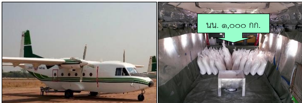
ภาพที่ ๘ ลักษณะการจัดเรียงสารปนหลวงบนอากาศยานชนิด CASA
