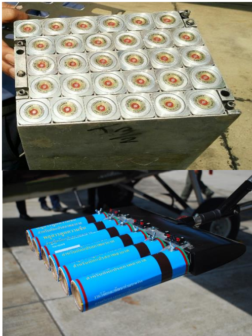
ภาพที่ ๑๑ การบรรจุสารฟลางฟลูซิเวอร์ไอโอไดต์ (Agl) และฟลูดูดความชื้น (Hygroscopic Flares)
