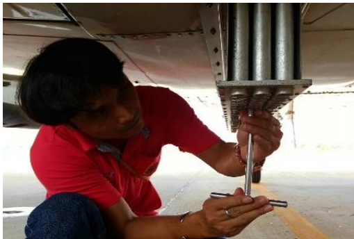
ภาพที่ ๑๒ การบรรจุและติดตั้งพลุซิลเวอร์ไอโอไดด์กับอากาศยานชนิด Super King Air (SKA)
