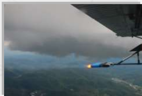
ภาพที่ 2.15 แสดงติดตั้งอุปกรณ์สำหรับพลุสารดูดความชื้นและการใช้พลุสารดูดความชื้นเครื่องบิน AU23A (ซ้าย) และรูปแบบการบินในการใช้พลุสารดูดความชื้น (ขวา)
