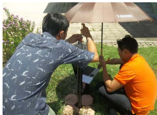
รูปที่ ข.6 แสดงขั้นตอนการติดตั้งสถานีวัดฝนตั้งแต่เริ่มต้นจนเสร็จสิ้นและการทดสอบระบบ ระหว่างการติดตั้ง
