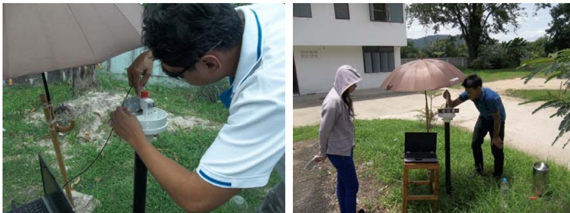
รูปที่ ข.7 แสดงการทดสอบและการบำรุงรักษาเครื่องวัดน้ำฝนอัตโนมัติของกรมฝนหลวงและการบินเกษตร
